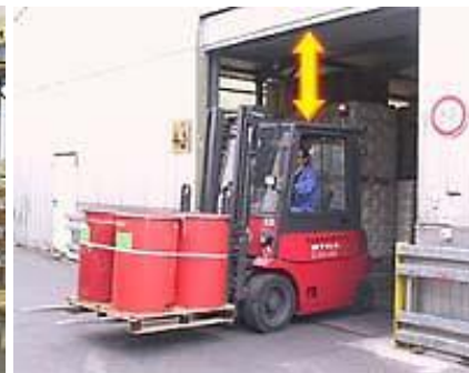
20 cm zwischen Mast und Durchfahrt
