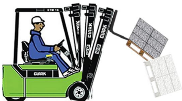
Bei einem ruckartigem Brems- oder Ausweichmanöver, sowie bei starkem nach vorne neigen des Mastes, kommt es meistens zu einem Unfall. Die Ware kann nicht mehr zurückgehalten werden.
