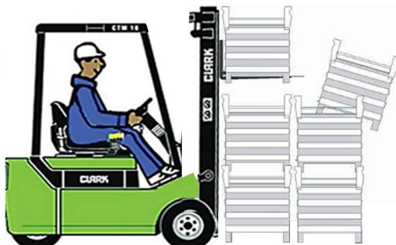
Zu lange Gabeln: Paletten hinter der aufgenommenen Ladung werden beschädigt. Vorsicht bei der Queraufnahme von Paletten!
