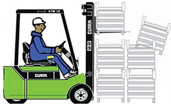
Des fourches trop longues: La prise des palettes provoque des dégâts.
