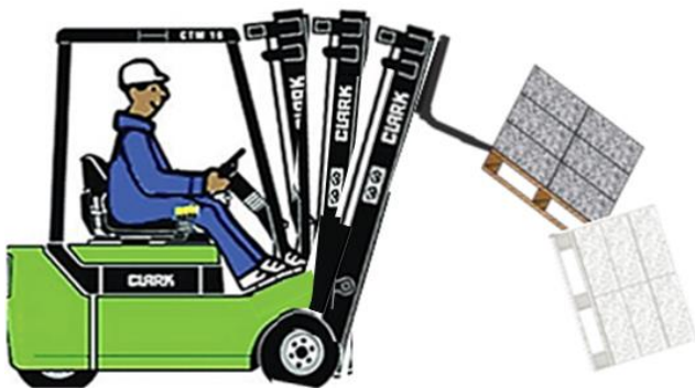
Avec un freinage brusque, un manœuvre de demi-tour ou avec un forte d'inclinaison du mât, la marchandise peut tomber.
